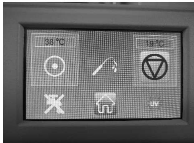
En caso de degradación de la lámpara UV, el sistema avisa al usuario para que compruebe y/o sustituya la lámpara:
