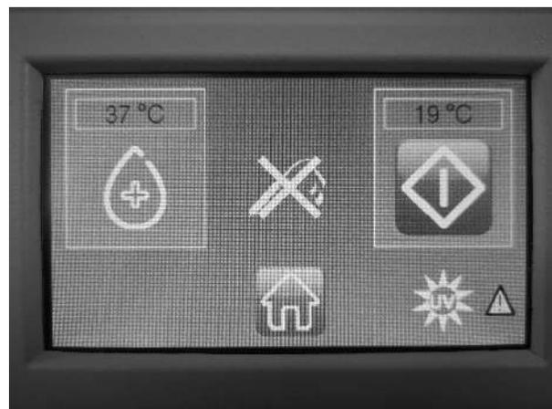
En caso de sobrecalentamiento de la lámpara UV, el sistema se bloqueará
