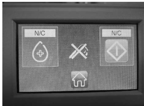
Si hay alguna fuga en el circuito de agua, active el sensor de fugas, bloqueando el sistema y apagando todos los periféricos:
